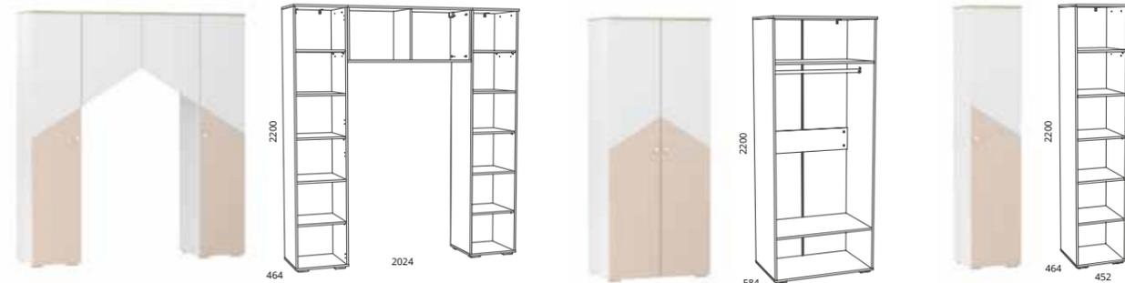
**NM 041.45** Шкаф комбинированный (представляет собой 2 шкафа для одежды соединённых между собой навесной полкой с двумя дверцами)
